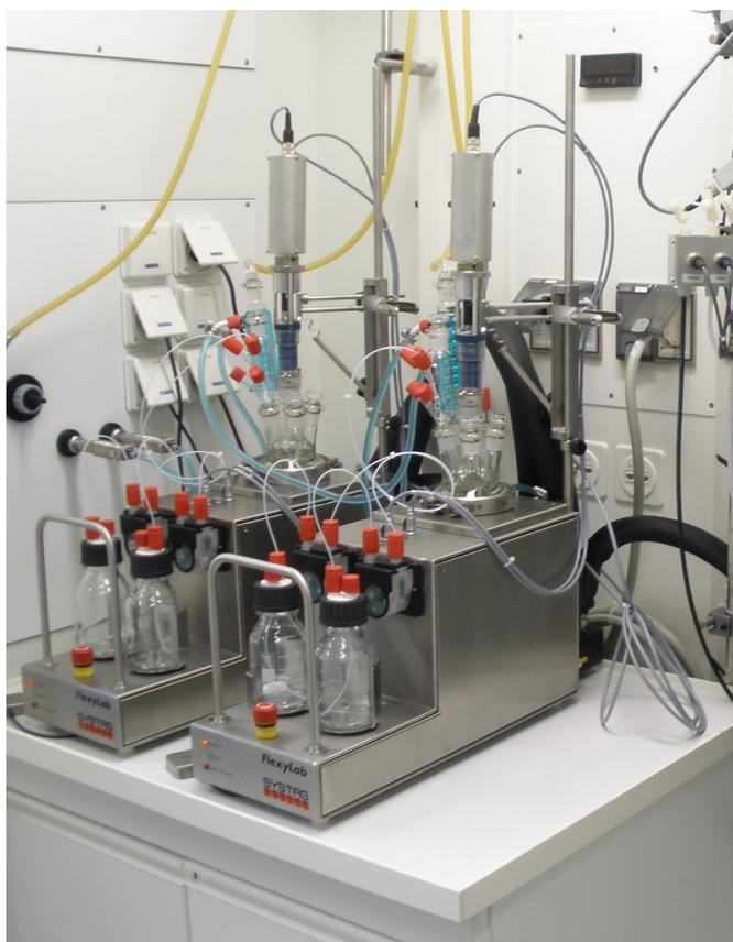
Chart 3: FlexyLab Parallel Workstation mit 2 Reaktoren
