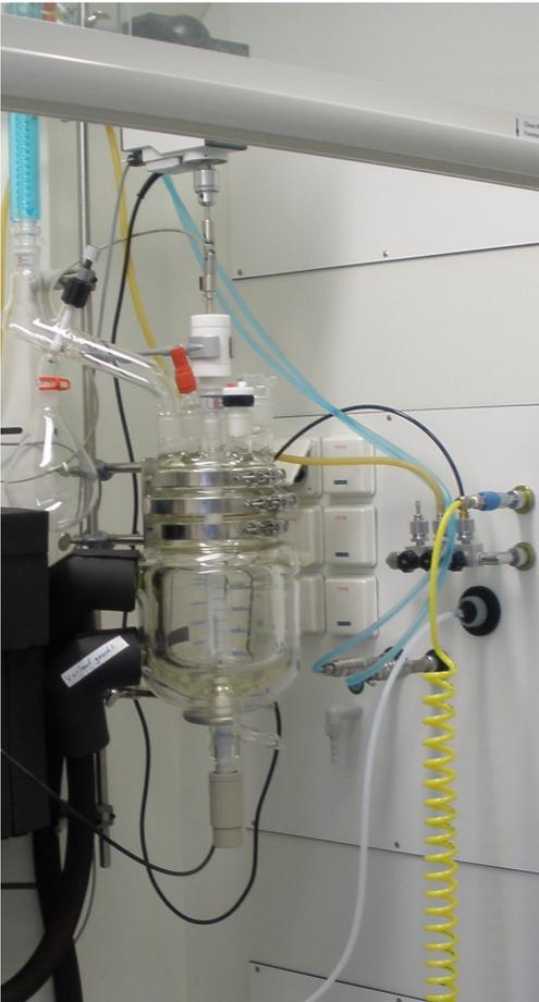
Chart 5: FlexyPAT - automatisierter Labor-Reaktor
